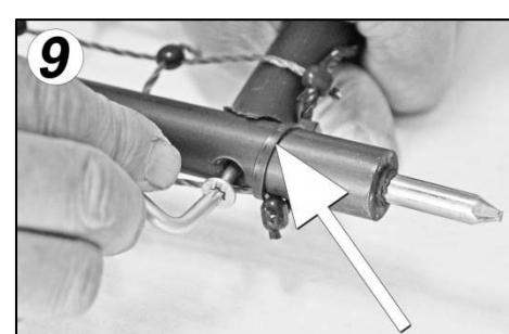
Beim Festschrauben der Strebe, diese bitte festhalten, um ein Mitdrehen zu verhindern (s. Bild 7).
